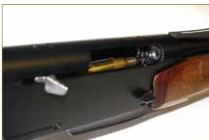
Pod vyhadzovacím okienkom je páčka vypúšťania záveru
